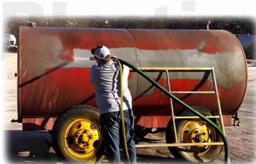
Cuando se combinan adecuadamente estos parámetros, el proceso de granallado húmedo puede llegar a ser competitivo con procesos de granallado seco en algunos casos especiales como lo son la remoción de capas de pintura gruesas, remoción de óxido o recubrimientos de láminas delgadas, concreto, madera o plástico.
