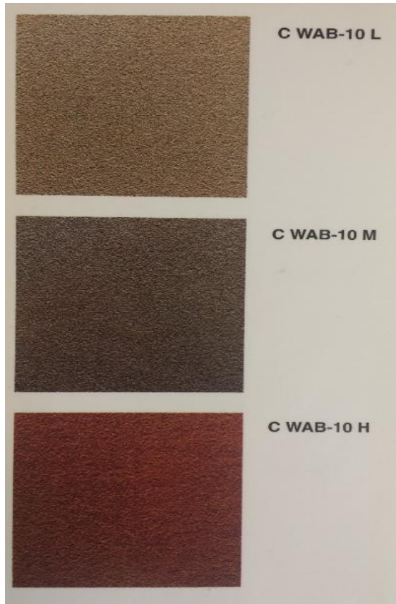
Figura 2 - SSPC-VIS 5 / NACE VIS 9 grados de corrosión prematura para el acero en Condición C preparado para SSPC-SP10
