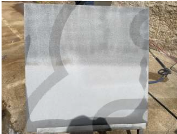
Panel de Prueba Después de la Aplicación de Corr-Ze™ 200 en la Esquina Inferior Izquierda
