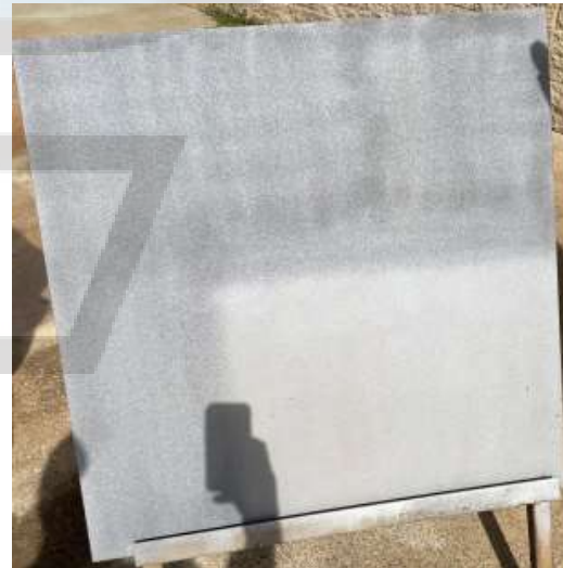
Panel después del Chorro de Agua con 1% de Corr-Ze™ 100
