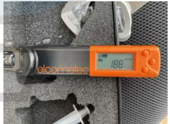
Sustrato: Resultado Bresle: 188 \mu\text{S}/\text{cm} , 226 \text{mg}/\text{m}^2 .
