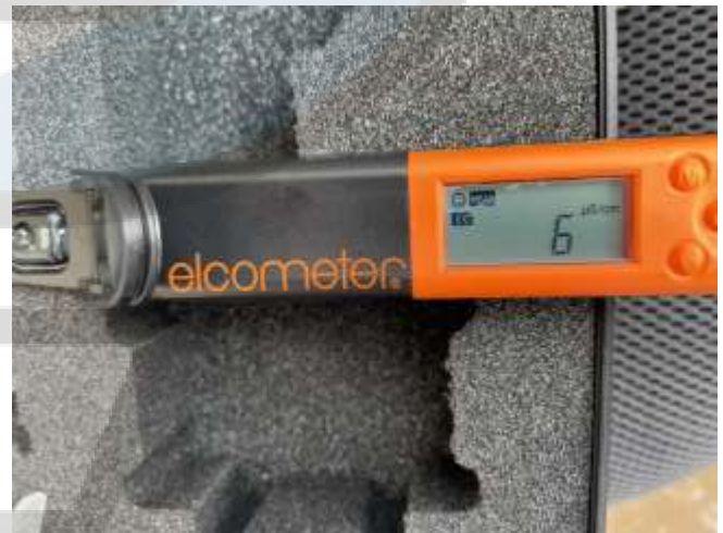
Después de la aplicación de Corr-Ze™ 200 (gel) y el lavado con Corr-Ze™ 100 Resultado Bresle: 6 \mu S/cm, 7 mg/m 2 .
