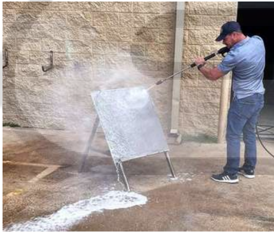
Chorro de Agua a 3000 psi con 1% de Corr-Ze™ 100 Presión: 3000 psi
