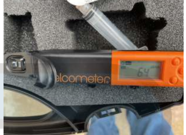
Panel Después de la Proyección: Resultado Bresle: 64 \mu S/cm, 77 mg/m 2 .
