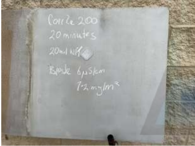
Sustrato después de la aplicación de Corr-Ze™ 200 (gel)
