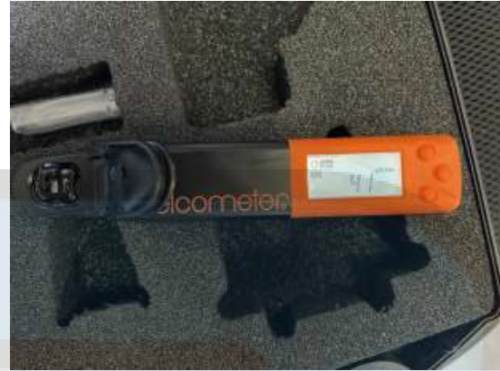
Panel de Prueba de Sustrato: Resultados Bresle 41 \mu\text{S}/\text{cm} , 49 \text{mg}/\text{m}^2 .
