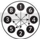
8 Lug Tightening Pattern
