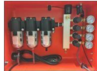
BB50 – CO4R Breather Box con Cuatro Reguladores Independientes
