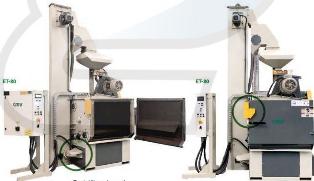
Cierre de Seguridad - Evita el Chorreado de Abrasivo con la Puerta Abierta
