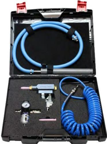
Pistola de granallado por succión, diseñada para uso profesional, con una alta resistencia a la abrasión.
