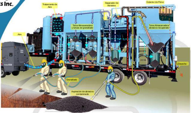
El uso del tráiler de granallado ADI en Tanques de almacenamiento permite el uso de granalla metálica para el proceso de granallado seco, permitiendo un ambiente con mínima nube de polvo, alta reciclabilidad de abrasivo, excelente limpieza de grandes áreas con tipo de limpieza y perfil de anclaje constantes y lo más importante, alta productividad y bajo costo.
