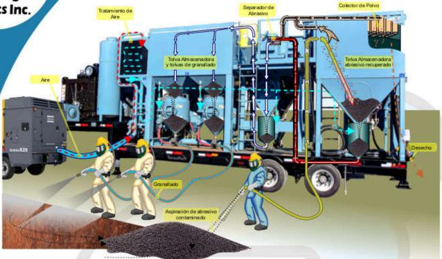
El uso del tráiler de granallado ADI en Astilleros permite el uso de granalla metálica para el proceso de granallado seco, permitiendo un ambiente con mínima nube de polvo, alta reciclabilidad de abrasivo, excelente limpieza de grandes áreas con tipo de limpieza y perfil de anclaje constantes y lo más importante, alta productividad y bajo costo.
