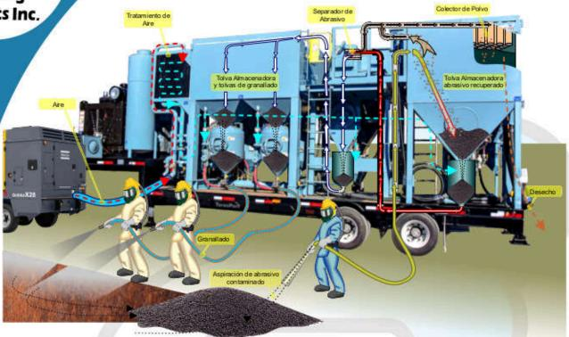
El uso del tráiler de granallado ADI en Puentes permite el uso de granalla metálica para el proceso de granallado seco, permitiendo un ambiente con mínima nube de polvo, alta reciclabilidad de abrasivo, excelente limpieza de grandes áreas con tipo de limpieza y perfil de anclaje constantes y lo más
